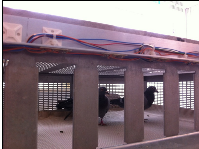
Figuur 10 Foto van het prototype 'multi-infraroodteller' (IR-teller) ontwikkeld door Gerard van der Heide uit Drachten. Het systeem bestaat uit een infraroodsensor boven elke drinkopening verbonden aan een data-opslagsysteem. Het systeem telt (turft) het aantal drinkbewegingen en slaat elke telling op, tezamen met het tijdstip en het nummer van de drinkopening.
